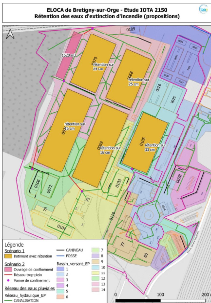
Figure 26 : Propositions rétention des eaux d'extinction incendie (source : rapport étude hydraulique TPAE)
